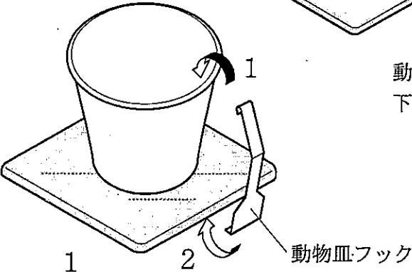
動物皿のふちにフック上側のツメを引っ掛けてから、下側のツメを計量皿の一辺の中央に引っ掛けます。
