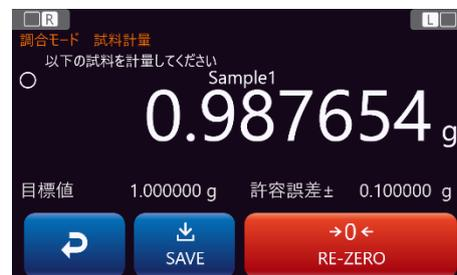
手順 4. レシピに登録した試料の数だけ、手順 2 と手順 3 の風袋計量と試料計量を繰り返します。
