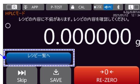
手順2 「**レシピ一覧**」画面にて、レシピを登録したい番号の行をタッチして選択します。例では、1番目に登録します。登録するレシピを選択したら、「**編集**」ボタンを押して、手順3の「**レシピ編集**」画面に移動します。
