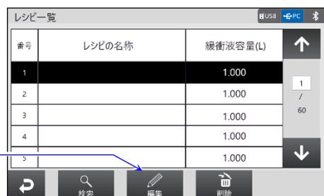
手順3 レシピ名を入力します。例ではレシピ名を「**PBS(-)**」、緩衝液容量を**1.000 L**、目標値の単位を**mmol/L**に設定します。設定後、「**編集**」ボタンを押して、手順4の「**試料編集**」画面に移動します。
