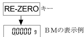
3. 試料を比重皿の上皿に載せ、空気中での重さを記録します。測定値Aとします。
