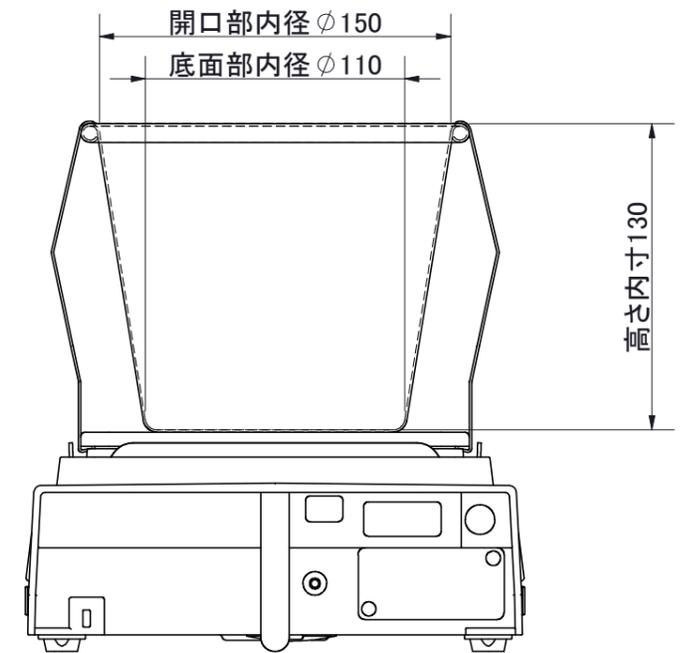
外観図 GX-A/GF-A 0.01g/0.1g系 GXA-12 動物皿キット装着時
