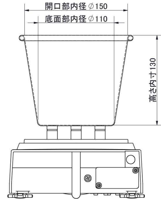
外觀図 FX/FZ/FX-i/FZ-i 0.01g系 FXi-12-JA 動物皿キット装着時
