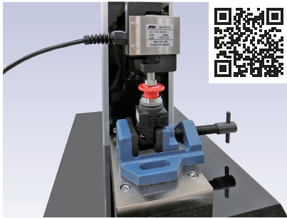
包装容器の圧縮強度試験
