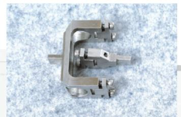
固定端式3点曲げ治具
