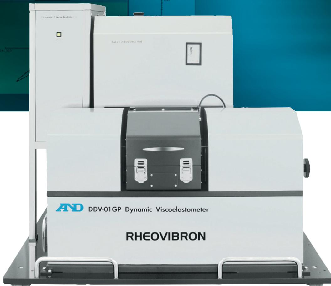
レオバイブロンDDV-GPシリーズは、プラスチックの動的機械特性の試験方法である
