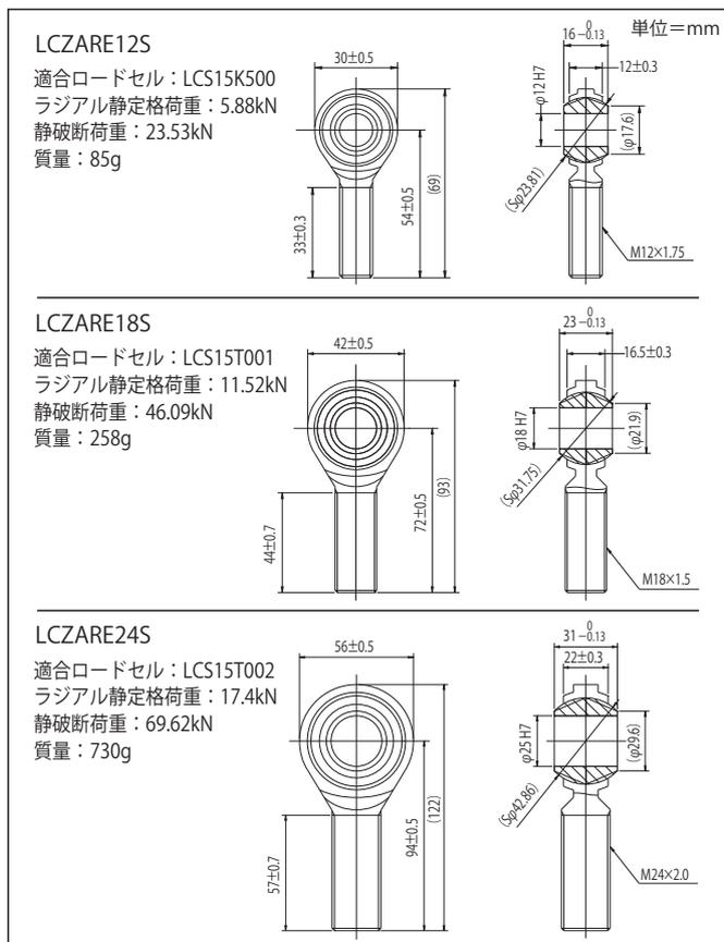
※ステンレス製ロッドエンドベアリング使用時は常用荷重を定格容量の1/2以下にしてください。
