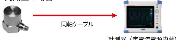
アンプ内蔵型加速度変換器は、変換器内部のアンプ回路で電荷信号を電圧信号に変換してから出力する変換器です。アンプ回路は測定器からの定電流電源により駆動させます。ケーブルの影響によるノイズにも強く、同軸ケーブルでの長距離配線で安定した測定ができます。
