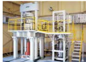
株式会社A&Dマニュファクチャリング日高事業所は、力基準機として国内最大の【10MN(圧縮)】から国内最小の【10N(圧縮/引張)】まで校正可能な力基準機群を所有し、広範な校正範囲を1社でカバーします。
