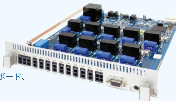
ECUへのVB電源供給用リレーを10系統分備えたリレーボード、
