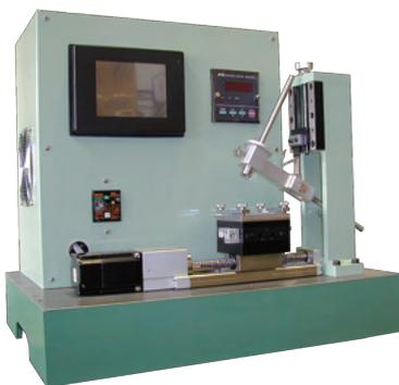
動面、材料の表面状態を摩擦力の測定によって評価するものです。摺動面を潤滑状態、温度環境下での試験をする装置も用意できます。
