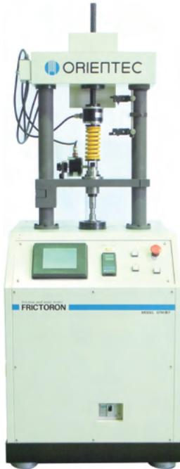
EFM-3 シリーズは、JIS K7218 に適合した A 法(リングオンディスクとリングオンリング)及び B 法(ピンオンディスク)の対応した摩擦摩耗試験機です。
