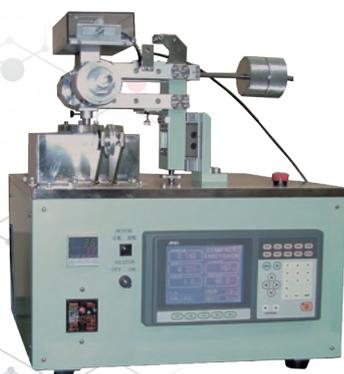
回転する板状試料と鋼球の鋼板表面の摩擦摩耗特性の評価装置です。バランスウエイト等の採用により試料がソフト接触します。摩擦時に発生する振動も考慮し、2本の平行リンク機構を採用しています。
