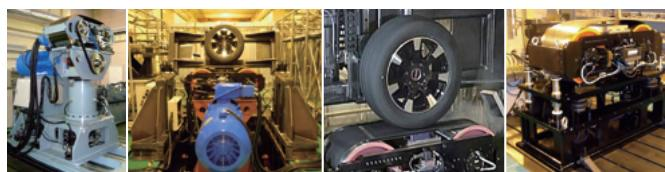
上下&amp;ステア方向加振機能を備えたムービングベルト装置の実際
