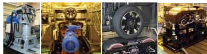
上下&amp;ステア方向加振機能を備えたムービングベルト装置の実施例
