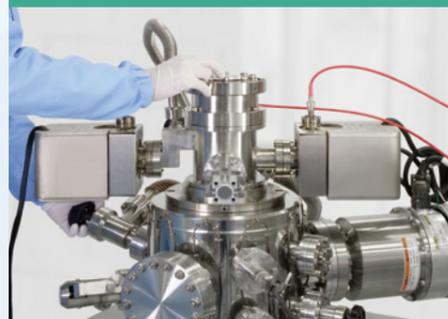
ナノレベルで計測できる電子顕微鏡や微細加工装置に組み込む電子銃などを開発し、半導体製造の微細化技術を支えています。
