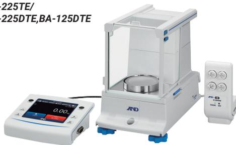
■ 最小表示 0.01mg ■ カラー液晶表示 (タッチパネル)
