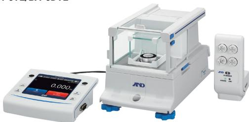
■ 最小表示 1 $\mu$ g ■ カラー液晶表示 (タッチパネル)
