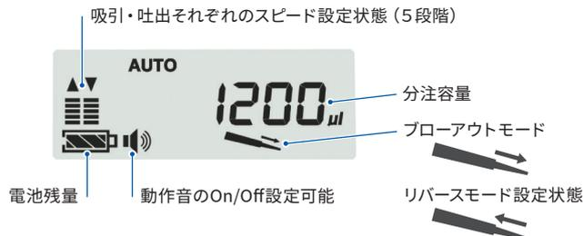
動作モード、分注容量などのユーザー設定は、ピペット本体に最大9種類登録可能。必要時に読み出すことで再設定の手間を省略(電源Off後も直前に使用した設定を記憶)
