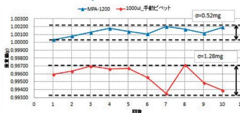
吸引・吐出一連の動作の中で、ピストンスピードが精度に影響を及ぼします。手動式ではそれが操作者に依存する為、連続作業の中で、特に後半になって差が出てくる傾向があります。MPA/MPBシリーズでは、吸引・吐出それぞれ5段階で速度を設定することが出来て、毎回同じ速度で動作する事で、高い精度を実現させています。
