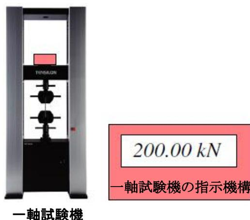
**赤い力計:**一軸試験機の力計測系に使用される力計
