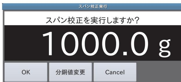
図 57 スパン校正実行ダイアログ
