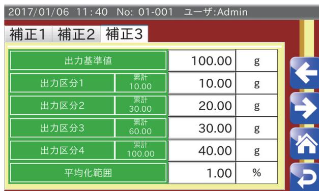
図 75 10段階フィードバック機能設定画面
