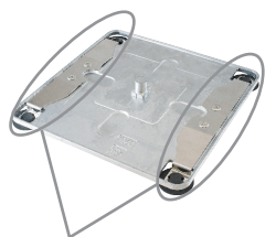
ショックアブソーバー 機構付き計量皿 (センサ部にかかる衝撃を和らげる構造)
