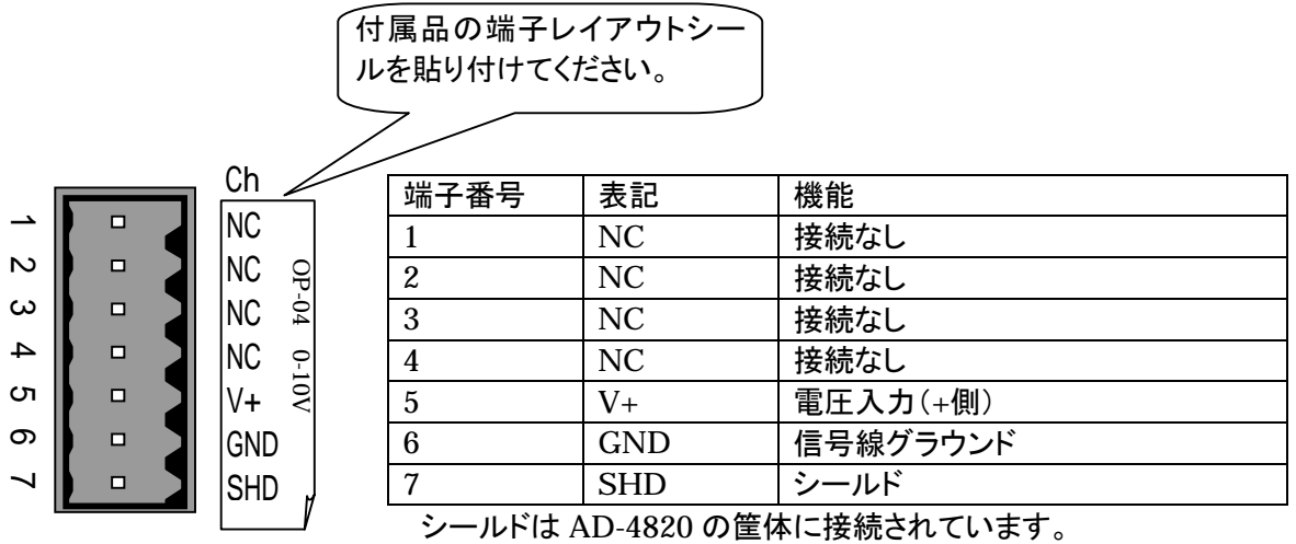
図 10 OP-01 に取付けたときのパネル面のピンアサイン
