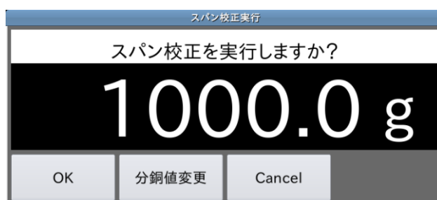
図 62 スパン校正実行ダイアログ
