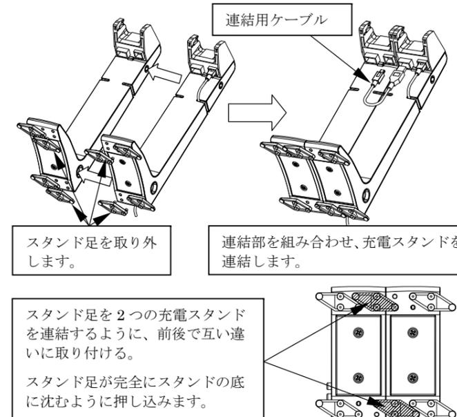
4. 連結用ケーブルで、充電ハンガー部の出力部④と増設スタンドの入力部③を接続します。
